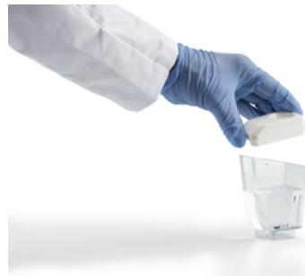
3. Füllen Sie den Wiederaufbereitungsbehälter mit Desinfektionsmittel bis auf einen Stand zwischen MIN und MAX und setzen Sie den Deckel auf.
