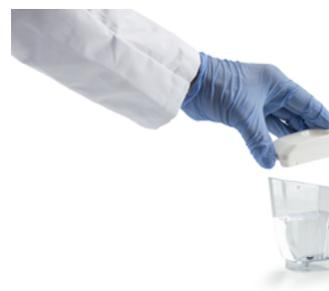
7. Füllen Sie den Wiederaufbereitungsbehälter mit 70%igem Isopropylalkohol bis auf einen Stand zwischen MIN und MAX und stecken Sie den Deckel auf.
