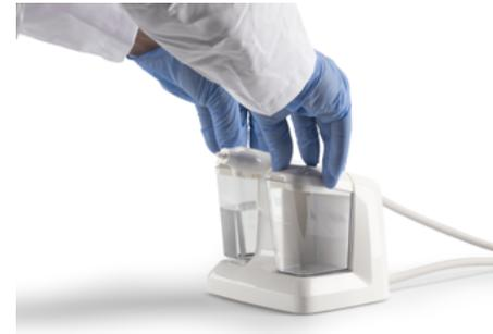
12. Füllen Sie den gereinigten Vorratsbehälter mit deionisiertem Wasser und stellen Sie ihn in die Basiseinheit. Füllen Sie nicht über die MAX-Markierung hinaus.
